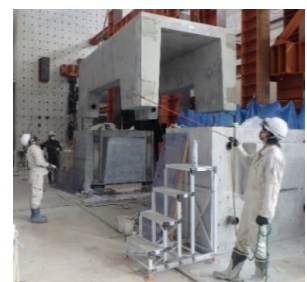
施工性確認実験 実物大のプレキャスト部材で 施工性を確認
