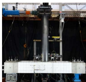
正負交番载荷実験 杭頭接合部の 曲げ耐力性能を評価
