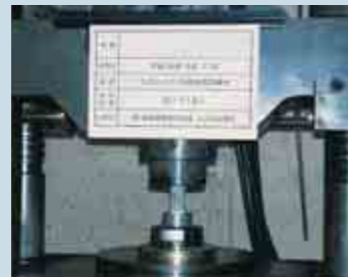
(圧縮強度試験)
