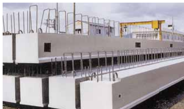
プレテンション方式スラブ橋げた
