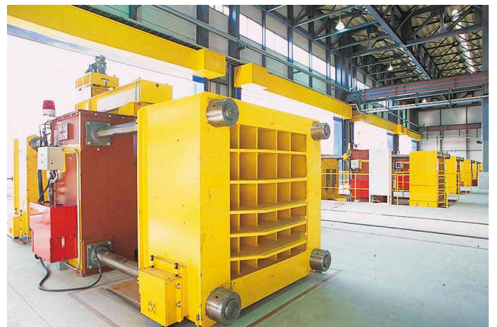
緊張設備(プレテンション緊張装置) ( 6000KN4基・7000KN 2基 ) プレテンションベンチ ( 6000KN×68.55m 4基・7000KN×68.55m 2基 ) ボイラー設備 ( 貫流ボイラー 4基・最高使用圧力 0.98MPa )
