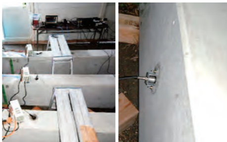
センサー技術を活用したPC鋼材の破断検知に関する実験
