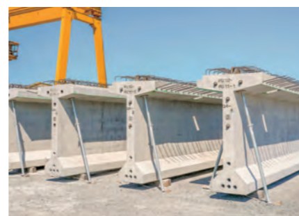
セグメントT桁(コンボ橋)
