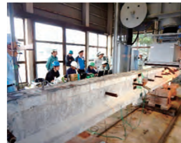
センサー技術を活用したPC鋼材の破断検知に関する実験
