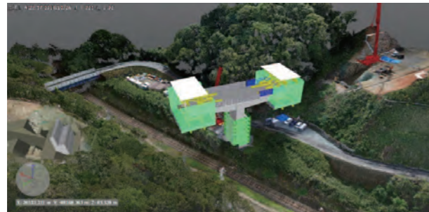
4D施工シミュレーション
